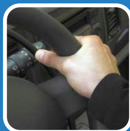
C. Empujar el aro con el pulgar desde el interior del volante
